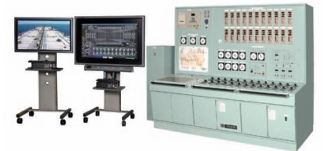
教育用エンジンシミュレーションシステム
