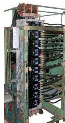
多段積み温度試験の状況
