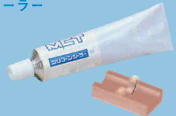
防水・気密用などの場合にご使用下さい。上の写真のようにインサートブロック中心部分およびインサートブロックとエンドパッキンの外表面・フレーム内の四隅・フランジ取付面にも塗布して下さい。(1枠に1本ご使用下さい。)
