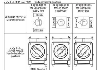
(6): ハンドルキャッチから内部を見て、変更する遮断器取付け方向に対応し たハンドルとギヤの係合になっていることを下表より確認します。 Visually check the inside from the handle catch to see if the handle is engaged with the gear properly. See the table below.
