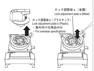
: 下表より, 変更する遮断器取付け方向に対応したロック調整板の位置を選び, 組替え ます。例えば左電源供給形のハンドルに変更する場合,下表より"B"の位置にロック調
