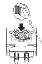
下表より、変更する遮断器取付け方向に対 応したハンドルはめ込み位置を選び、はめ 込みます。
