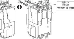
・電源側の裸導体間はブレーカ端面まで全て絶縁して下さい。 Insulate all bare conductors of the line side until the breaker end
