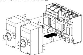
電気的インターロック用ケーブル Electrical interlock cable
