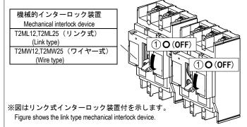
②電動操作装置からシールを剥します。 2) Tear off the seal from a Motor operator.
