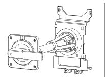
パネルマウント式 外部操作ハンドル 取扱説明書 Panel-Mounted External Operating Handle
