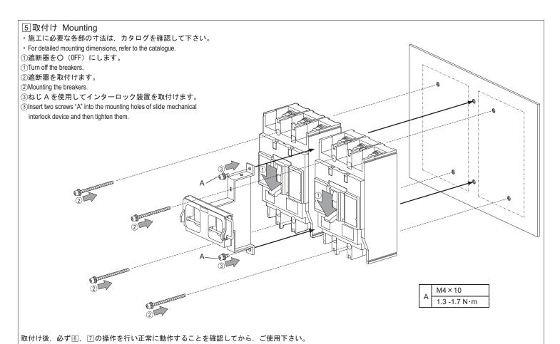
After mounting, verify the function of the Slide Mechanical Interlock Device. (Refer to ⑥ and ⑦) ※取外しは、上位遮断器等を切(OFF)にし、主回路及び制御回路が充電していないことを確認して行って下さい。感電の
