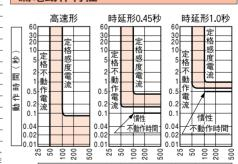
地絡電流(定格感度電流に対する%) (時延形の動作時間は0.45秒の場合0.15~0.45秒、1.0 秒の場合0.6~1.0秒の間で動作します。
