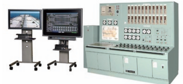
教育用エンジンシミュレーションシステム
