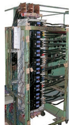
多段積み温度試験の状況
